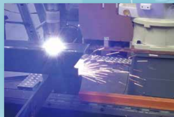
プラズマ切断
