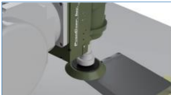
厚板・ガス切断のノロ取り
