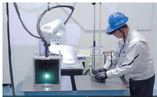
ロボット溶接と人によるワーク設置を並行実施
