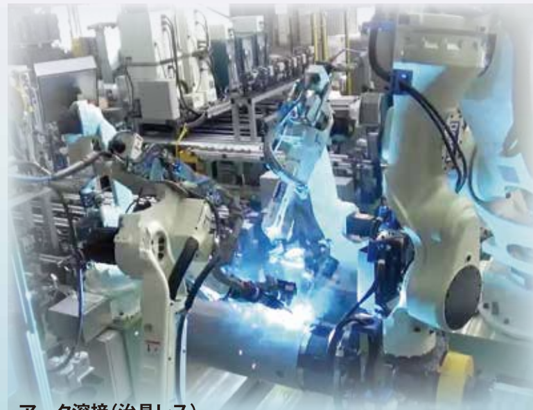
アーク溶接(治具レス)
